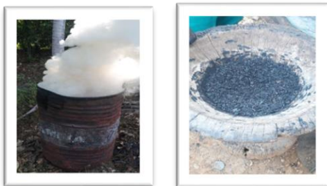
Gambar 2. Proses karbonasi bahan baku (A), proses penghalusan arang hasil karbonasi (B).
