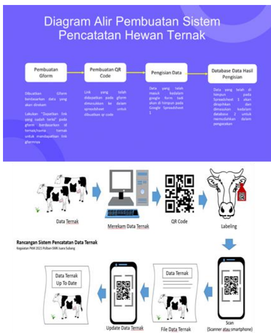
Gambar 2. Diagram alir pembuatan sistem pencatatan hewan.
