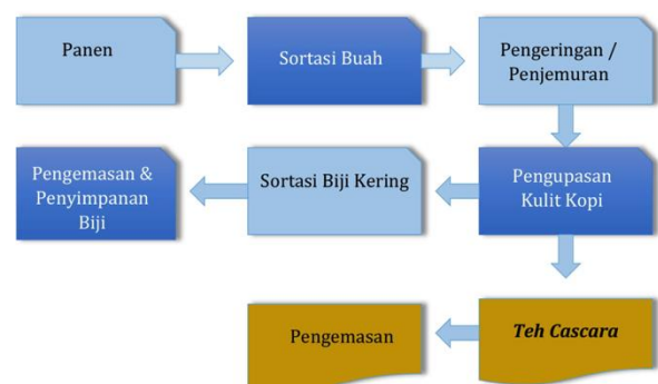
Gambar 3. Flowchart Pembuatan Cascara Natural Proses
