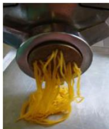
Gambar 4. Proses pencetakan mie dengan ekstruder
